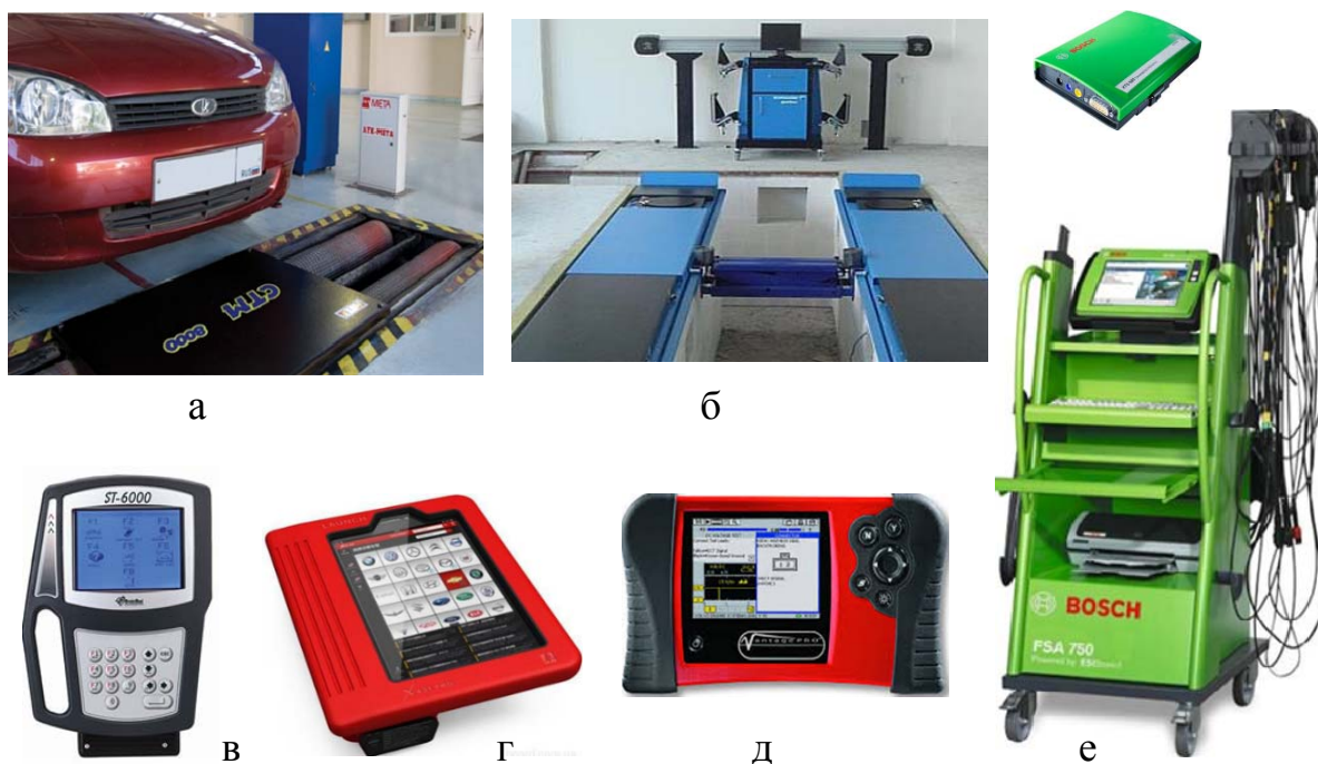
Рис. 7 Демонстрація засобів комп'ютерної діагностики: а – роликовий стенд; б – дільниця контролю геометрії колісної бази; в...е – прилади комп'ютерної діагностики мехатронних систем автомобіля
