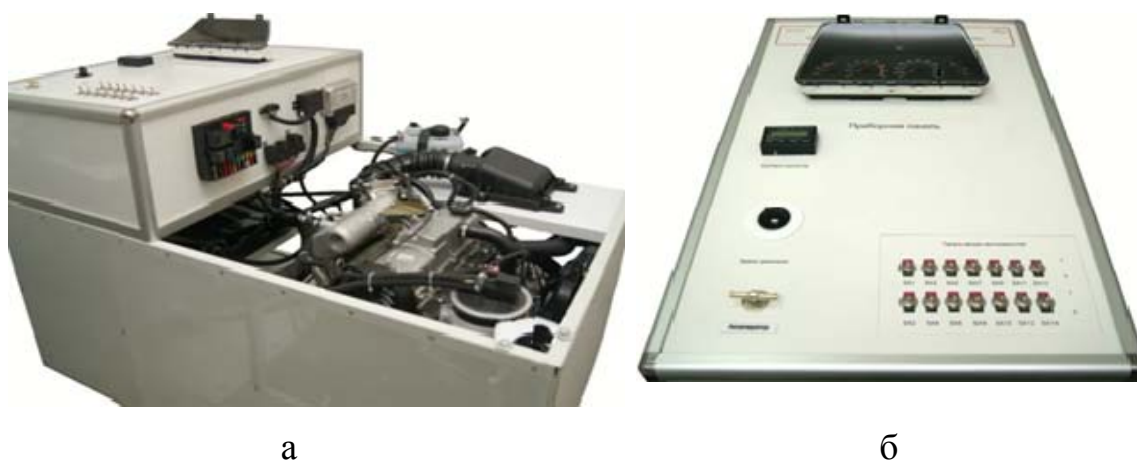
Рис. 4 Лабораторний стенд з автомобільним двигуном: а – загальний вигляд; б – панель оператора
